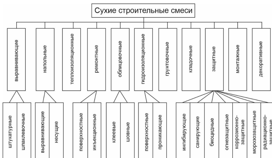
Рисунок 1. Классификация сухих строительных смесей по назначению.
