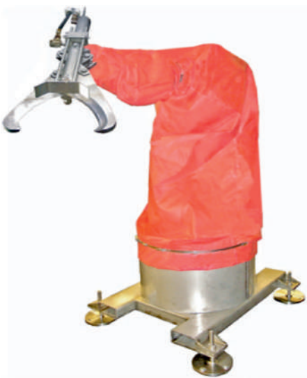
Рисунок 2. Робот, созданный компанией «Jarvis», осуществляющий отделение голов и конечностей свиней.
