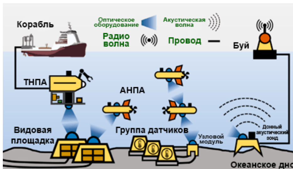
Рисунок 1. Концепция кабельной и бескабельной конвергенции в подводной телекоммуникационной наблюдательной сети.
