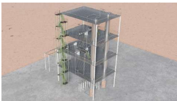
Рисунок 2. Трехмерное изображение реакторного блока с предварительным подогревом сырья.
