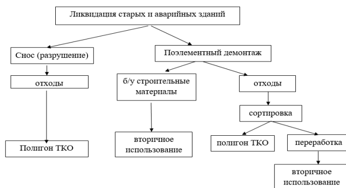
Рисунок 3. Схематичное изображение концепции снижения антропогенной нагрузки на окружающую среду за счет сокращения поступления строительных отходов сноса зданий на объекты размещения отходов.
