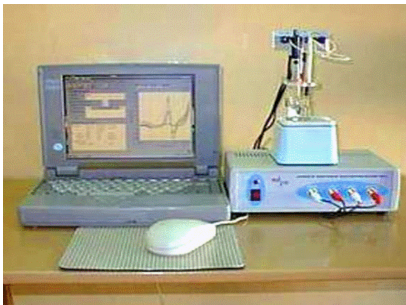
Рисунок 3. Инверсионный вольтамперометрический анализатор (ИВА) с трехэлектродной электрохимической ячейкой и компьютером с программным обеспечением.
