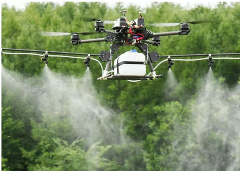
**Рисунок 1.** Дрон-распылитель DJI Agras MG-1 (источник: <https://www.dji.com/ru>).
