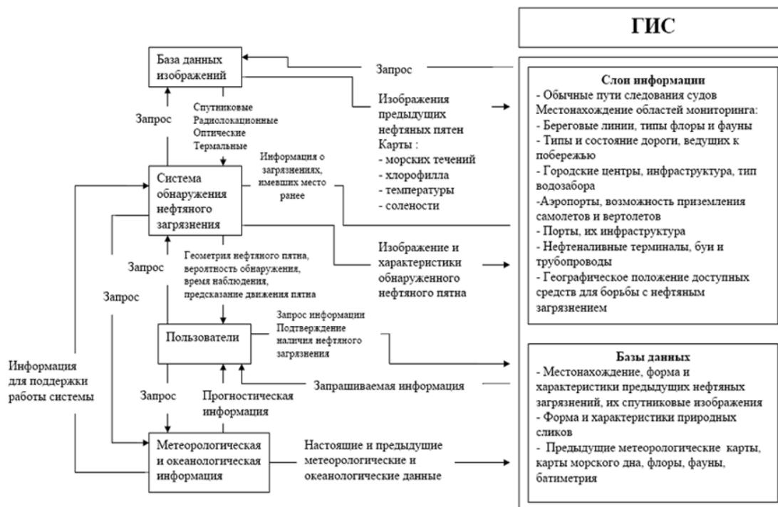
**Рисунок 1.** Схема автоматизированной системы дистанционного мониторинга водной среды.
