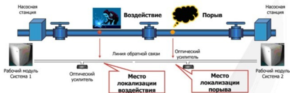
Рисунок 1. Схема ликвидации аварий на трубопроводе.
