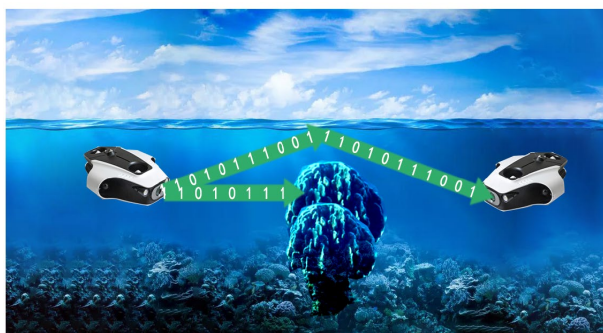
Рисунок 3. Подводные аппараты, использующие линии связи полного отражения на границе раздела воздух-вода.
