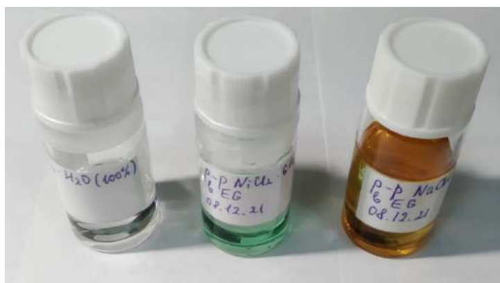
Рисунок 1. Слева направо: раствор гидразина гидрата в ЭГ, раствор хлорида никеля в ЭГ, раствор гидроксида натрия в ЭГ.
