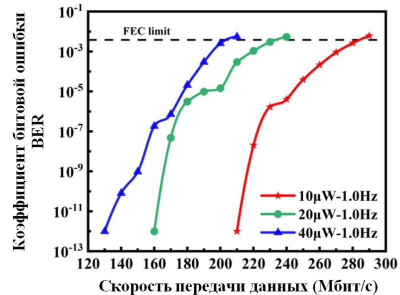
При наличии угла полного отражения  $7^\circ$  по оптическому каналу UWOC была достигнута максимальная скорость передачи данных 300 Мбит/с при коэффициенте битовой ошибки  $BER \approx 3 \cdot 10^{-3}$ . Результаты экспериментов показали, что волнение водной поверхности может привести к ограничению скорости передачи данных до 200 Мбит/с при коэффициенте  $BER \approx 2,57 \cdot 10^{-3}$ .
