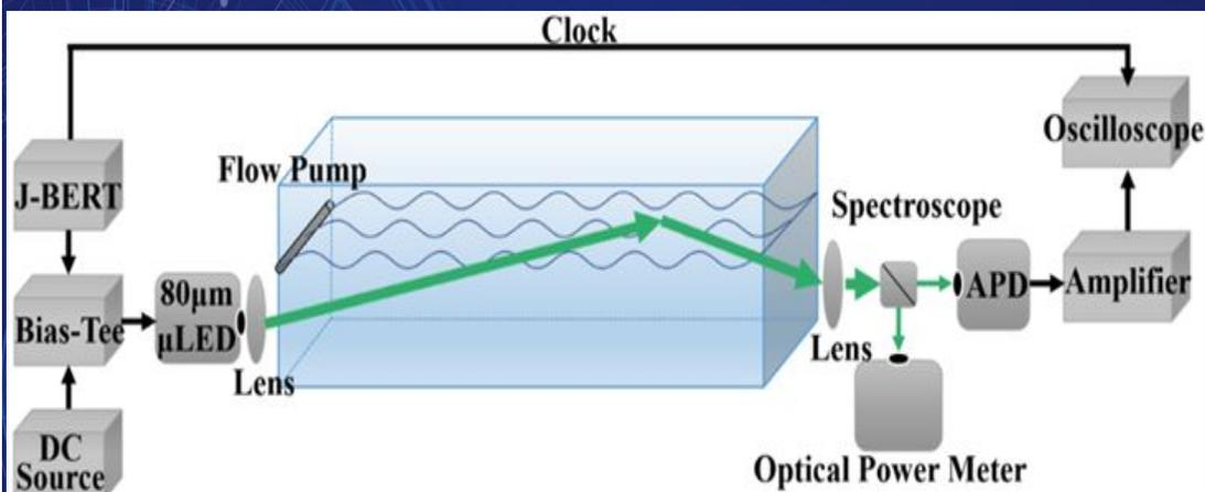
На рисунке представлена структурная схема для исследования линии UWOC, которая использует микросветодиод на основе технологии InGaN и двухпозиционную манипуляцию без возврата к нулю NRZ-OOK. Со стороны передатчика микросветодиод управлялся устройством тройного смещения, которое сочетает в себе постоянный ток (DC) от прецизионного параметрического анализатора KEYSIGHT B2902A с псевдослучайными двоичными последовательностями (PRBS) от анализатора Agilent J-BERT E8403A.
