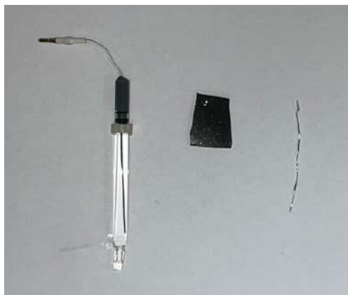
Рисунок 1. Три электрода: электрод сравнения (Ag/AgCl), вспомогательный (платиновый) и рабочий (стеклоуглеродная пластина).
