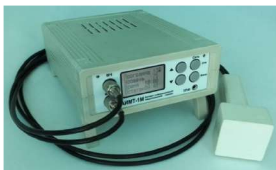
Рисунок 1. Устройство моделирования микроволнового излучения Солнца.
