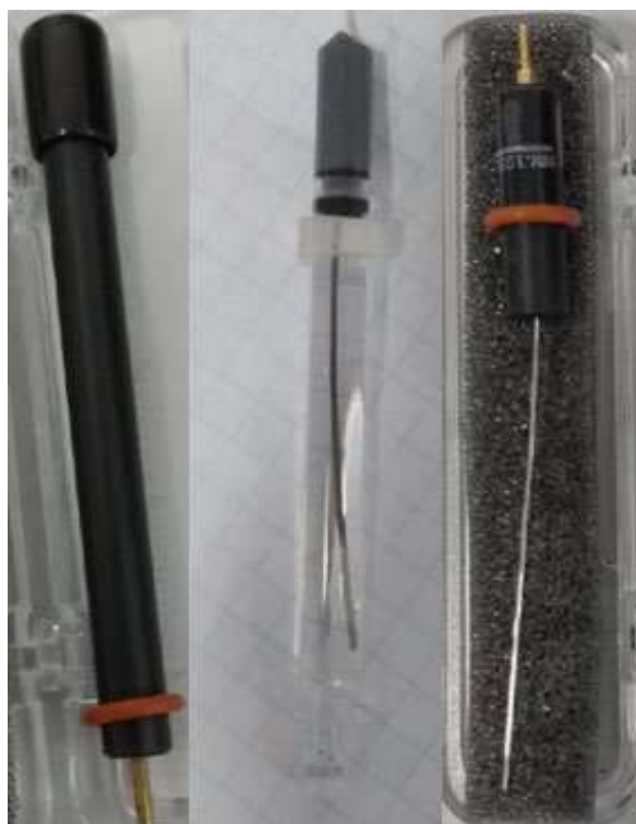
Рисунок 2. Электроды: рабочий (слева), сравнения (в середине), вспомогательный (справа).
