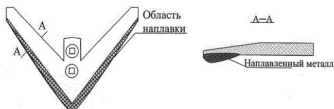
Рисунок 1б. Схема области наплавки износостойким сплавом «Сормайт».
